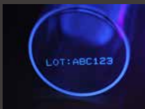
【ガラス用ステルスインク】 隠し印字用。通常は印字が見え ず、ブラックライトで照射する と印字が青く光ります
