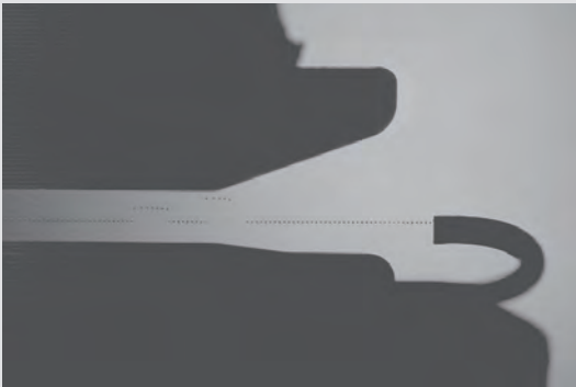
高速度カメラでのインク滴 飛翔評価
